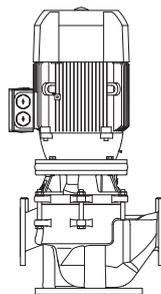
*Abb. 7-1 Zugelassene Einbaulage*
