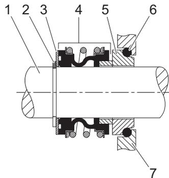
Abb. 10-5 Aufbau Gleitringdichtung mit Elastomerbalg und mit O-Ring
