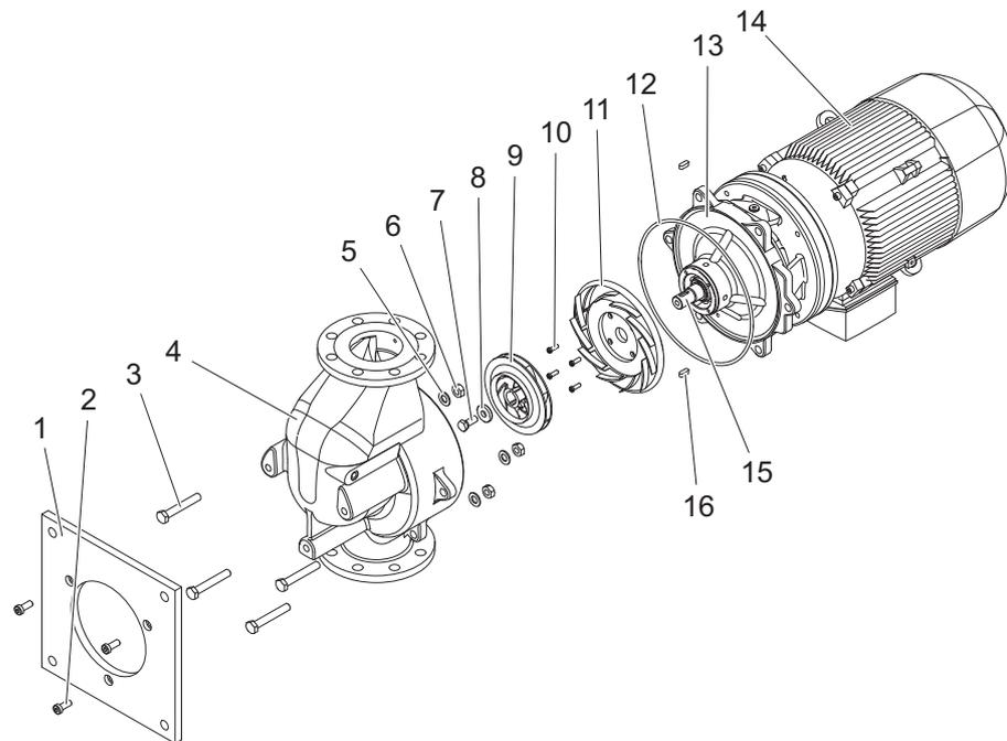
Abb. 10-7 Gehäuse montieren, Beispiel
