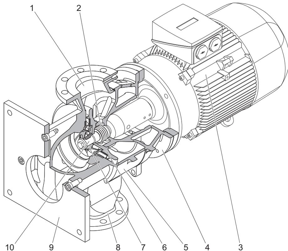
Abb. 4-1 Aufbau Pumpe
