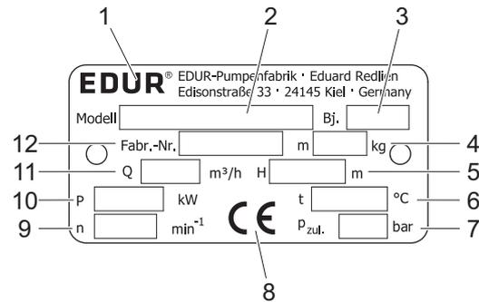
Abb. 1-2 Typenschild am Pumpengehäuse
