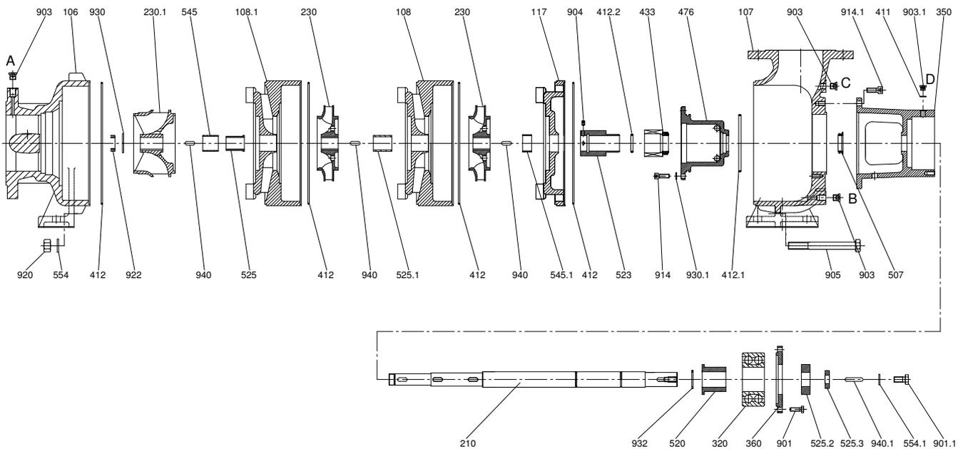
A: Verschlusschraube NPT 1/4" für Entlüftung und Manometeranschluss
