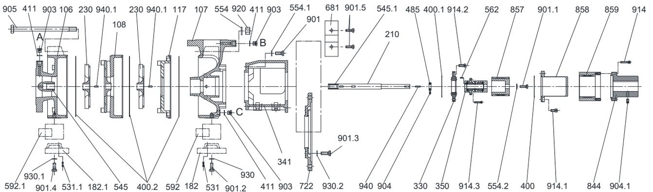
A: Verschlußschraube G1/4 für Entlüftung / Manometeranschluß
