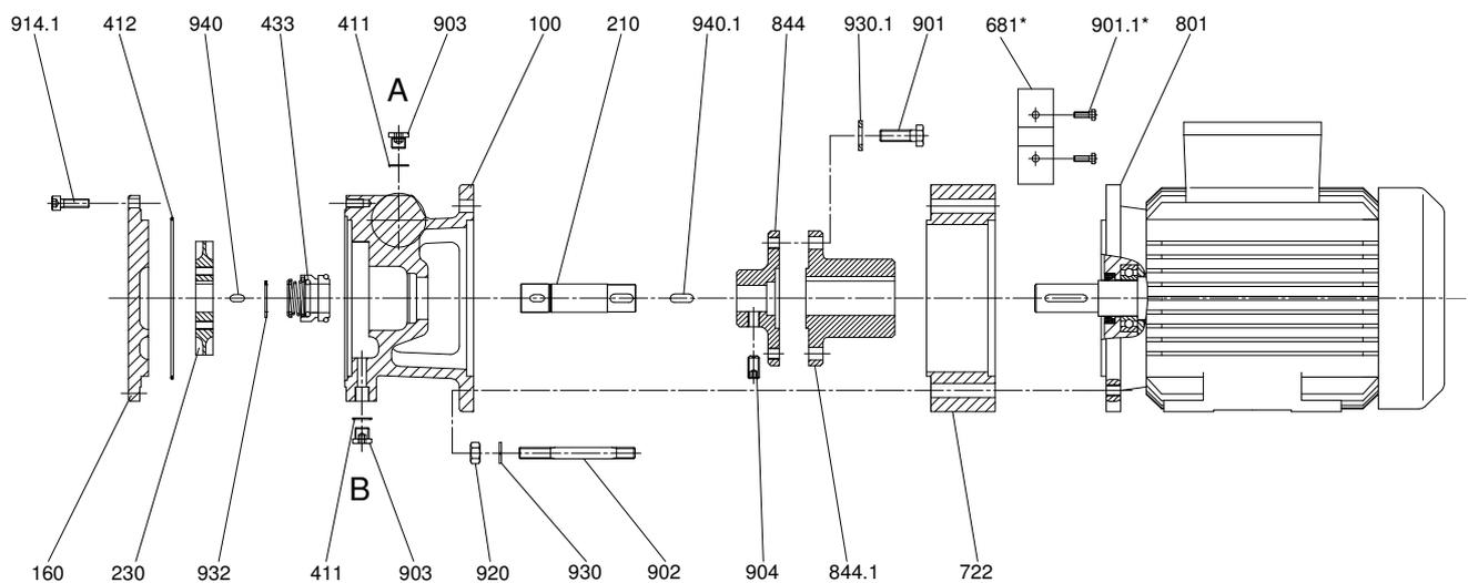
A: Verschlussstopfen G<sup>1</sup>/<sub>8</sub> für Entlüftung und Manometeranschluss
