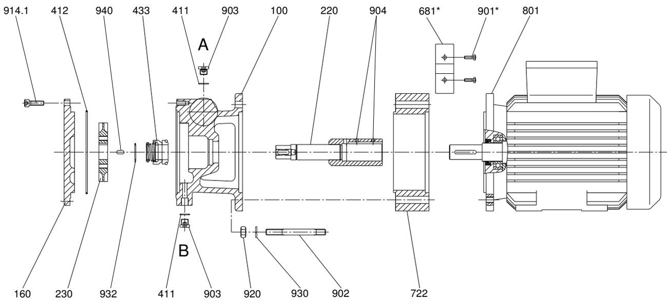
A: Verschlussstopfen G<sup>1</sup>/<sub>8</sub> für Entlüftung und Manometeranschluss
