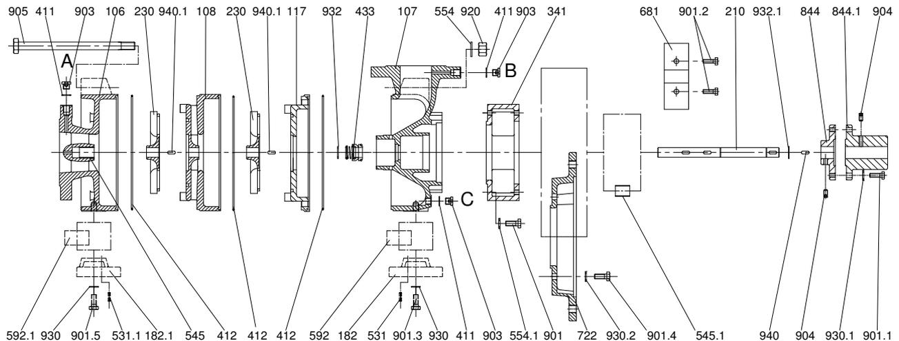
A: Verschlusschraube G1/4 für Entlüftung / Manometeranschluss
