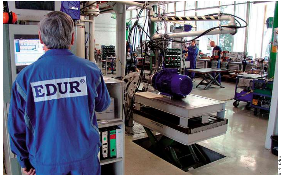
Die Edur-Mitarbeiter haben im Rahmen des KVP-Prozesses das Prüffeld für Kreisel- und Vakuumpumpen eigenständig untersucht und überarbeitet.
