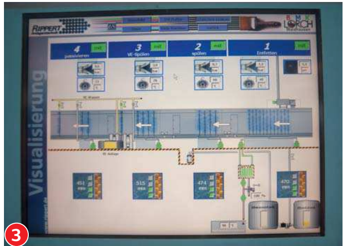
Bild 1: Auch in der Vorreinigung der zu beschichtenden Bauteile laufen diverse Pumpen – beispielsweise für die Hochdruckreinigung. Bilder: Weinzierl
