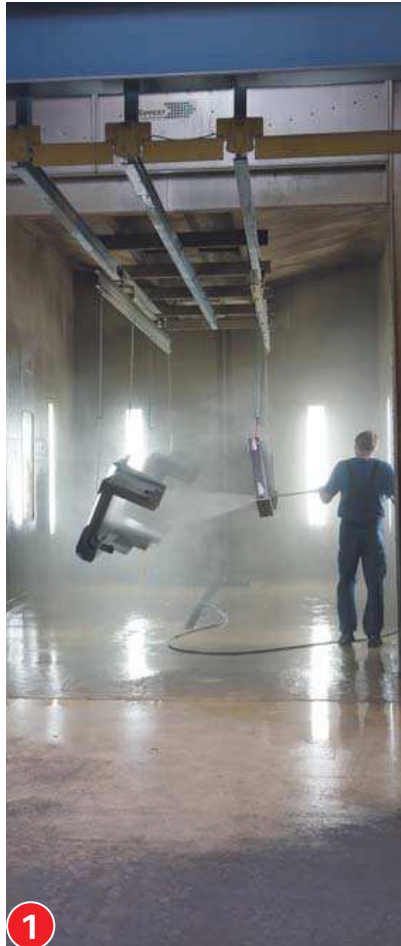
Bild 1: Auch in der Vorreinigung der zu beschichtenden Bauteile laufen diverse Pumpen – beispielsweise für die Hochdruckreinigung. Bilder: Weinzierl
