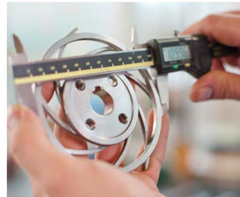
*Präzision im 100stel Millimeterbereich: Ein Laufrad wird mit dem Messschieber vermessen.*
