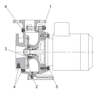
Fig. 10-1 NUB tightening torques
