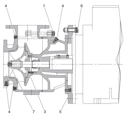
Fig. 10-3 NUBS tightening torques
