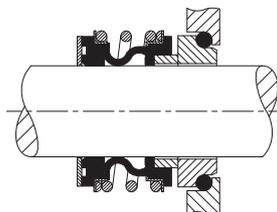
*Abb. 4-3 Aufbau Gleitringdichtung mit Elastomerbalg und mit O-Ring*
