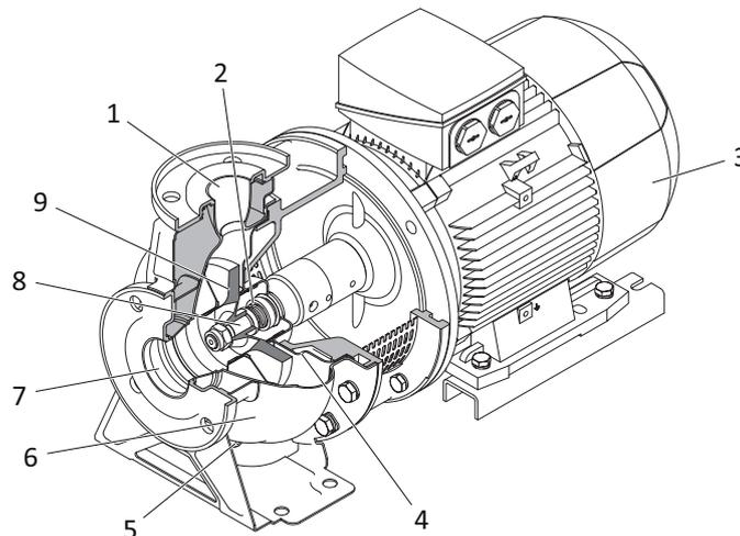
Abb. 4-1 Aufbau Pumpe
