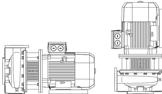
Abb. 7-1 Zugelassene Einbaulage
