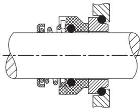
*Abb. 4-2 Aufbau Gleitringdichtung mit Kegelfeder*
