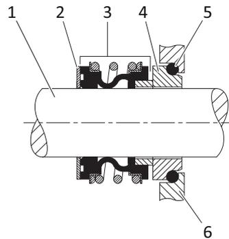
Abb. 10-3 Aufbau Gleitringdichtung mit Elastomerbalg und mit O-Ring
