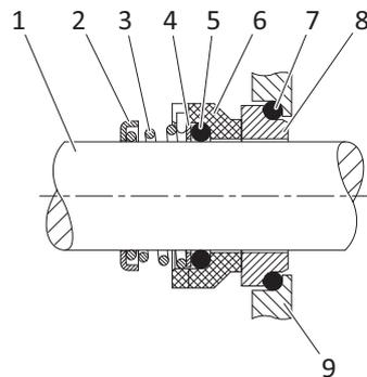
Abb. 10-4 Aufbau Gleitringdichtung mit Kegelfeder
