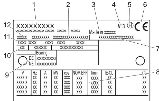
Abb. 1-3 Typenschild Motor
