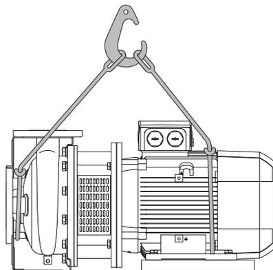
Abb. 5-1 Pumpe mit einem Kran transportieren
