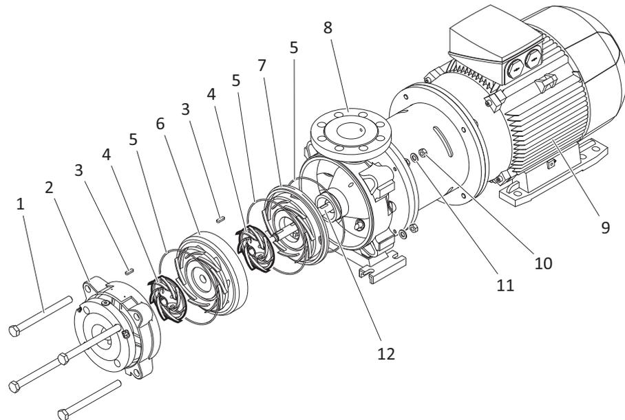
Abb. 10-2 Gehäuse demontieren und montieren, Beispiel
