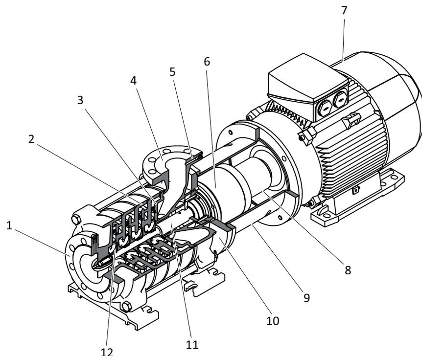
Abb. 4-1 Aufbau Pumpe
